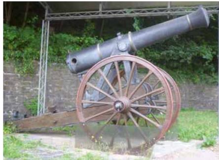
„Bei den beiden Kölner Kanonen handelt es sich um in Lüttich hergestellte preußische C/61 Geschütze der Festungsartillerie. Die Bauart, mit den auf die Lafettenwände aufgesetzten eisernen Böcken und der Richtmaschine, lässt darauf schließen, dass die beiden 12-zügigen 12-Pfünder mit Warendorffschem Kolbenverschluss zur Festungsverteidigung, der Überlieferung nach in Köln, eingesetzt waren. Diese Konstruktion ermöglichte eine größere Schussweite durch gezogenen Rohre,
